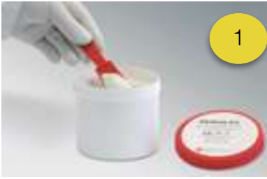
Toma de material con cuchara dosificadora
